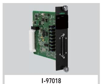
8-channel Thermocouple Input Module
